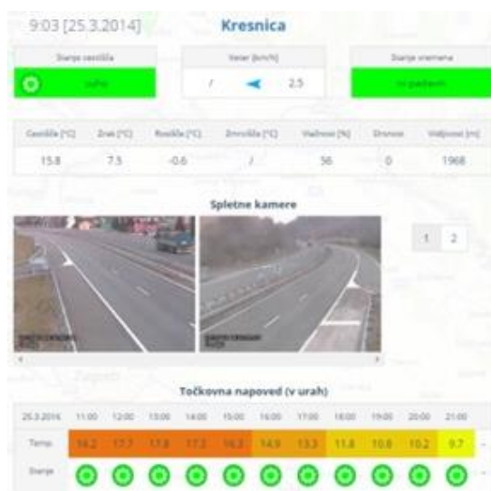
Slika 1: Uporabniški vmesnik, ki zagotavljajo pregled nad vsemi pomembnimi podatki, ki so povezani z izvajanjem zimske službe
